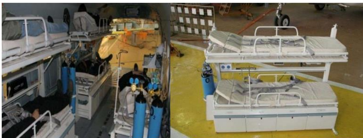
Рис. 3 Модуль медицинский вертолетный
