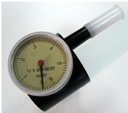
Рис. 9.3.3.1. Внешний вид механического спирометра
